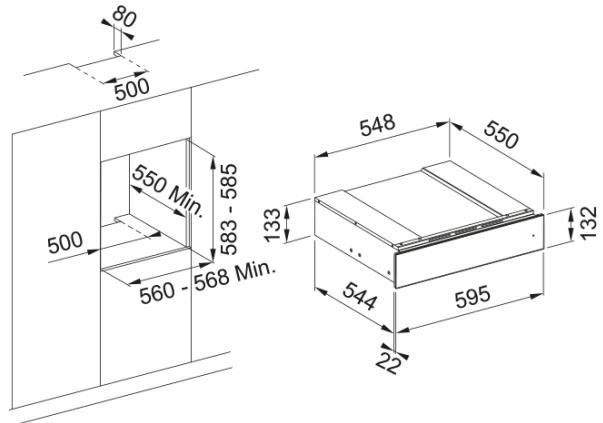
Tiroir chauffant - ouverture push pull - thermostat réglable de 40 à 75 °C - 14 cm - charge jusque 25 Kg - inox
