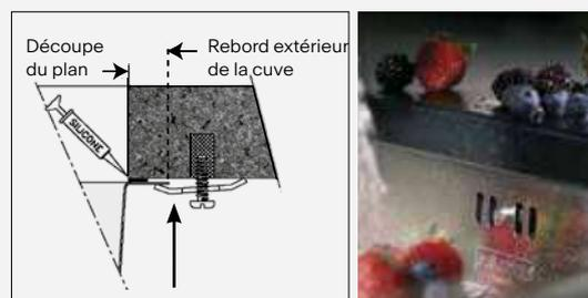
La cuve (ou l'évier) vient se fixer sous le plan de travail. Il convient d'effectuer scrupuleusement la découpe du plan à l'aide du gabarit ou d'un plan coté.
