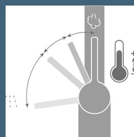
Limiteur de température : Retirer la manette, tourner la bague à l'intérieur pour ajuster la température et ainsi faire des économies\*.
